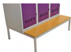
Socle banc H33,7 cm Tubes d'acier 30x30mm, soudés. Assise composée d'un plateau ép 25mm en hêtre PEFC vernis polyuréthane
